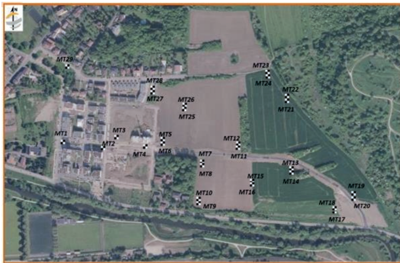
Implantation des essais d'infiltration (type Matsuo) – Février 2021
